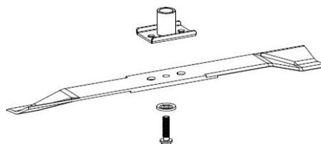
Pour retirer la lame, desserrez la vis, vérifiez le support de la lame et remplacez toutes les pièces si elles sont usées ou endommagées.
