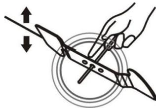
La lame est fabriquée en acier trempé. Pour obtenir un travail propre, affûtez la lame fréquemment, environ toutes les 25 heures d'utilisation. Assurez-vous que la lame soit toujours bien équilibrée. Introduisez un petit axe en fer (de 2 ou 3 mm de diamètre) dans le trou situé au milieu de la lame: celui-ci doit rester horizontal. Si la lame ne reste pas horizontale, équilibrez-la en l'affûtant davantage du côté où elle penche.
